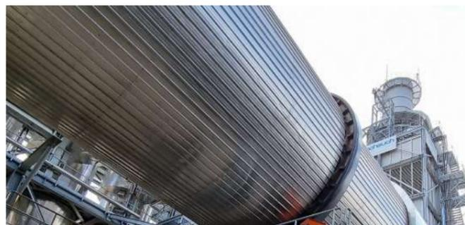
Nel 2021 è stato rinnovato il "cuore" del processo di Saib: un nuovo impianto di essiccazione e un nuovo filtro elettrostatico a umido di ultima generazione hanno sostituito quelli precedentemente installati.
